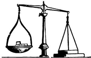
reemplazarse sucesivamente por una pequeña plancha de hierro, y de aquella madera que se emplee de preferencia en el país para los instrumentos agrícolas. Hecho esto, se aplica el disco ó plancha á la tierra y se van colocando pesos al otro platillo hasta que aquel se despegue, en cuyo caso las pesas nos dirán el mayor ó menor grado de adherencia al suelo de una tierra respecto de otras.
